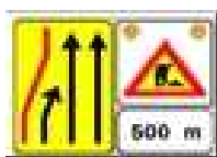
Esempio di presegnale di cantiere mobile
